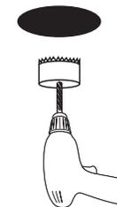
Faça o corte no forro com uma serra-copo de 55mm
