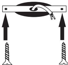
Fixe no teto a chapa de fixação da canopla de acabamento e passe os fios da rede elétrica no furo central
