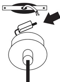
Com a rede elétrica desligada, conecte os fios do driver e isole com fita isolante antichamas
