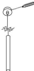
Encaixe a canopla no teto e parafuse nas laterais
