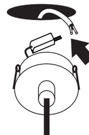
Com a rede elétrica desligada, conecte os fios do driver e isole com fita isolante antichamas
